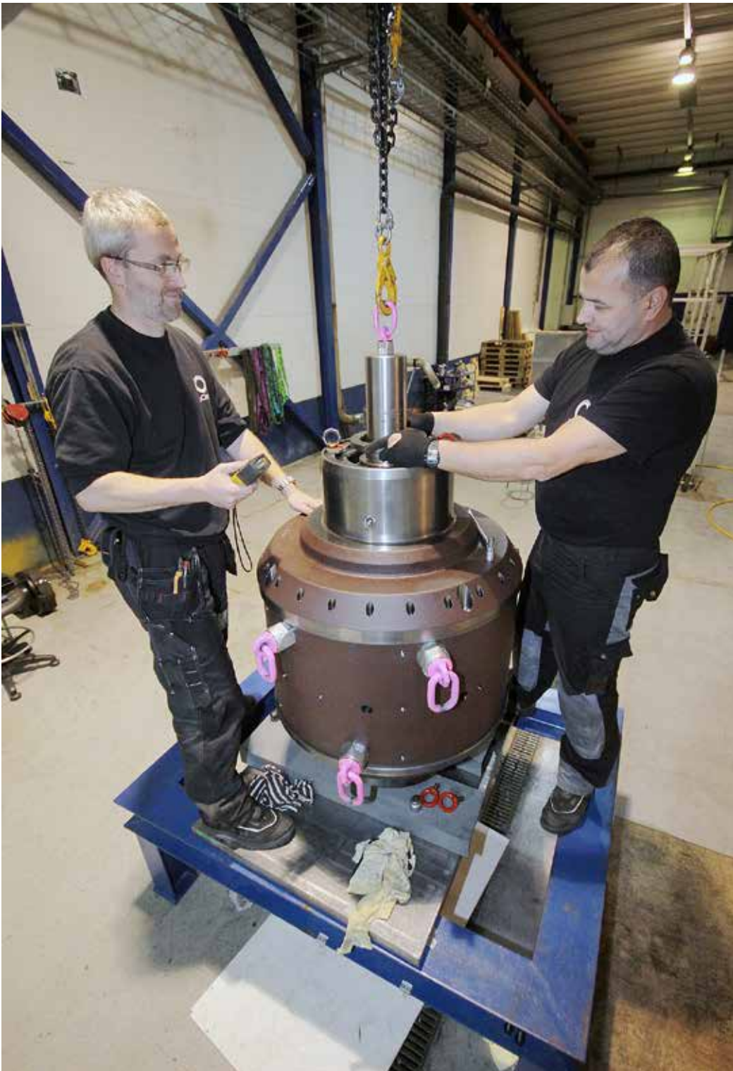
I høst testes den første av i alt fire såkalte dampekspandere som Tocircle har solgt til Hønefoss Fjernvarme. Her gjør Frode Hansen (t.v.) og Safet Omercevic nødvendige tilpasninger.
