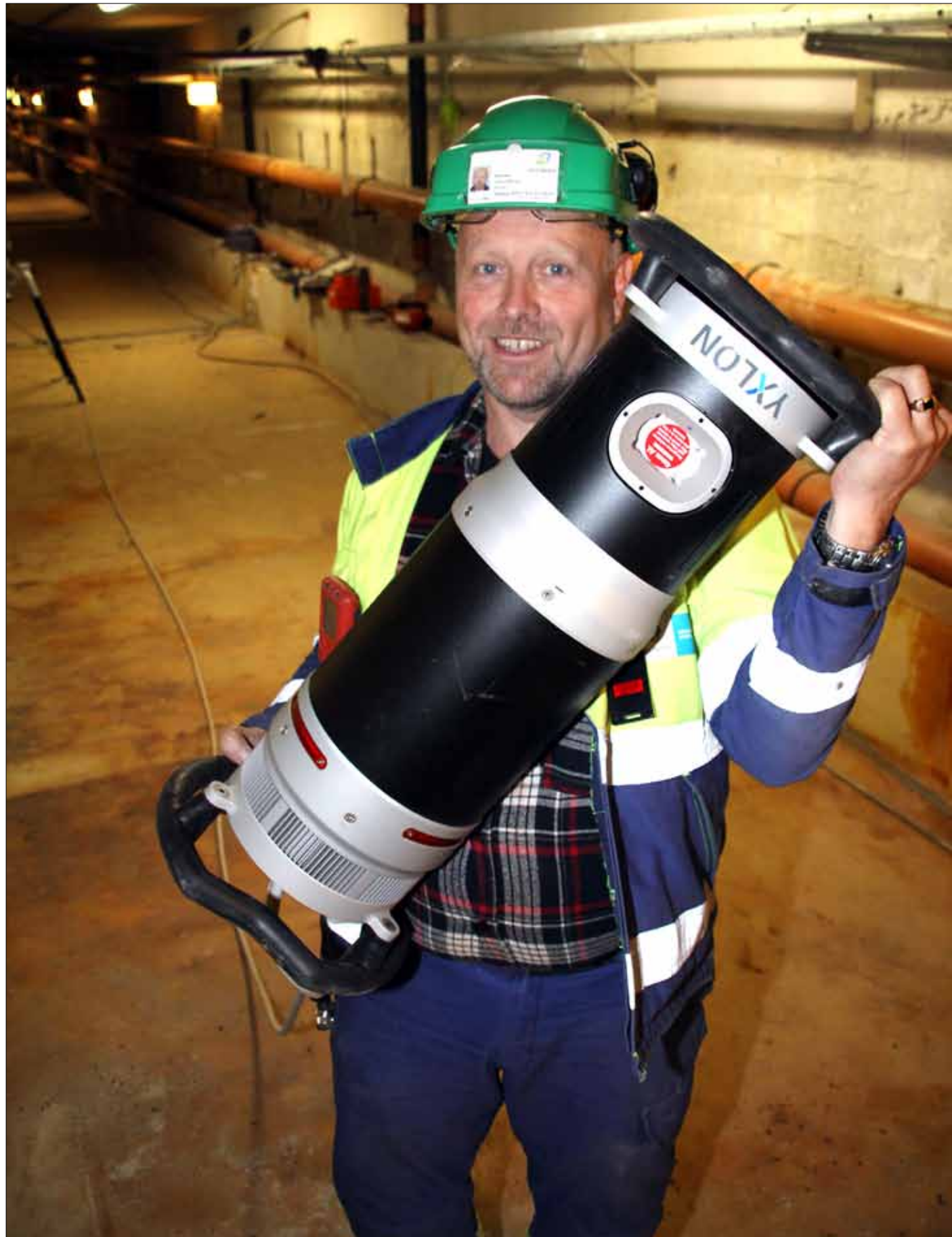
Det er tungt, viktig og verdifullt utstyr han håndterer, John Werner Breckan, når han utfører non destructive testing på kritisk utstyr i Yara-produksjonen. Her med Bilfingers nye røntgenapparat verdt 350.000 kroner.
