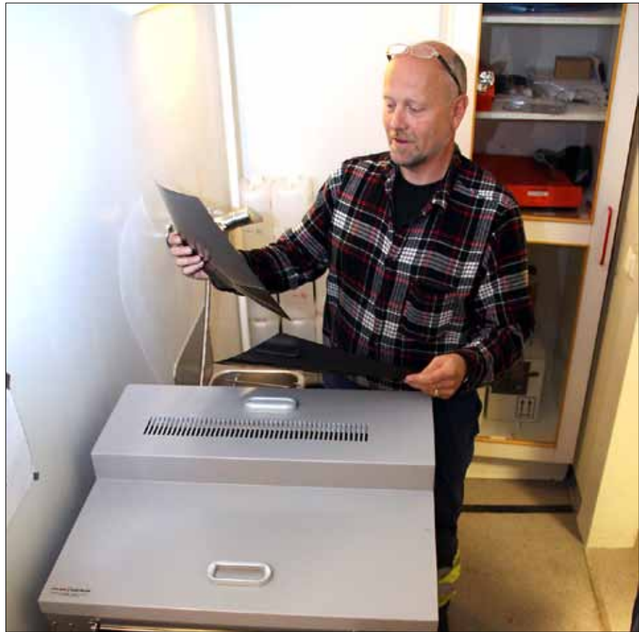
Det nye røntgenapparatet er tilpasset digital framkalling, men foreløpig trykker John Werner ut røntgenfilm på egen maskin i verkstedet sitt. Før han studerer nøye i lysbordet, på jakt etter sprekker.
