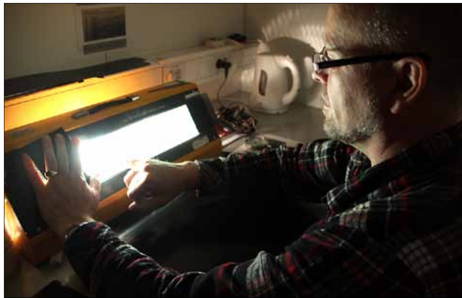
Det nye røntgenapparatet er tilpasset digital framkalling, men foreløpig trykker John Werner ut røntgenfilm på egen maskin i verkstedet sitt. Før han studerer nøye i lysbordet, på jakt etter sprekker.
